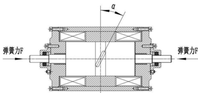
2、手动松闸复位后，定位装置自动定位，不会在电磁力作用下产生摆动，不会使制动器卡阻。
